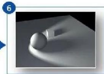
6 电风扇位于荧光灯下方，造成阴影干扰，导致照度不足
